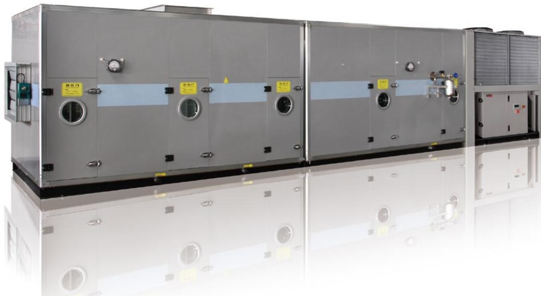
ZK-JD风冷净化空调机组自带冷、热源，由空调机组和室外机组成。机组内采用制冷剂直接蒸发的氟盘管，相比主机加空调机组的方式具有组成简单、安装方便、造价低廉的特点。设计中还特别采用封闭式双腔防冷桥型材和双S联接面板专利技术，并强调以综合性措施对细菌进行全面控制，成功解决了机组高压高强度、防冷桥和密封性等技术难题并消除了滋生细菌的可能性。
