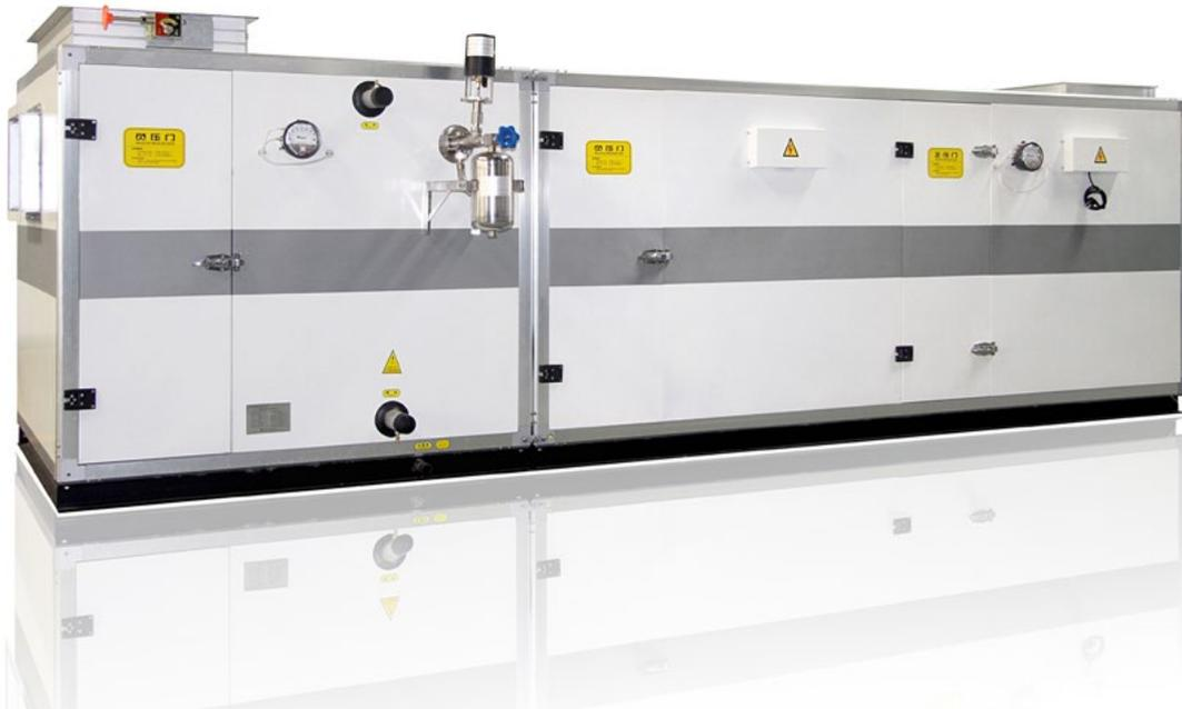
ZK-J系列净化空调机组是根据国标GB/T14294-2008、《洁净手术室用空调机组》和药品生产质量管理规范（简称GMP）等国家标准和规范要求研发生产的专用空调机组。机组风量范围从2000到12000m<sup>3</sup>/h，机组承压最高可达2500Pa。产品具有对空气进行降温、除湿、加热、加湿、过滤净化、杀菌消毒等功能。可广泛应用于医药、生物、电子、医院、食品等具有洁净环境要求的场所。
